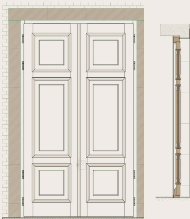
Двустворчатая дверь для частного дома: фасад и вертикальный разрез полотна. Наш рабочий чертёж, 2025 год
