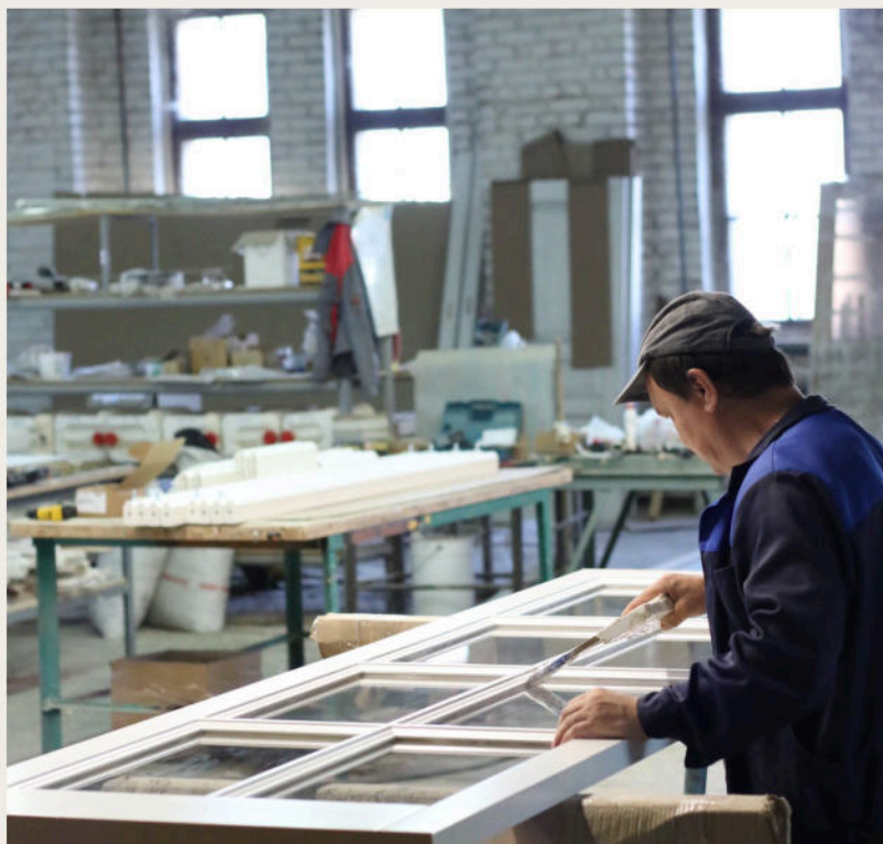
Дверной цех в Урмарах: сборка остеклённого полотна
